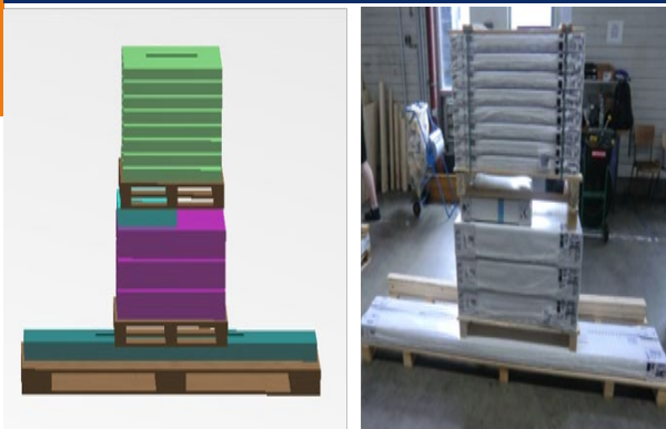
Flachheizkörperbündel: links Planung, rechts Ausführung
